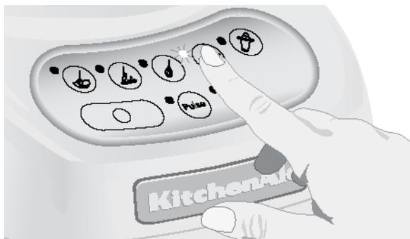
5. Для выключения импульсного режима (Pulse) нажмите кнопку "0". Теперь блендер готов к непрерывной работе.
