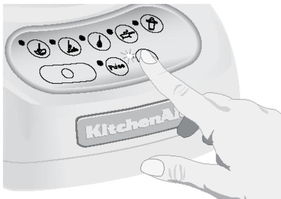
4. Для выключения функции измельчения льда (❄️) нажмите кнопку "O". Теперь блендер можно использовать в непрерывном режиме.
